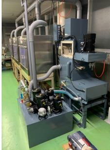
集中濾過循環システムとは、複数台の加工機に自動式遠心分離機を設置する場合、通常、1台の加工機に遠心分離機を1台設置します。集中濾過循環システムは、複数の加工機の処理を1箇所で行うことができるシステムです。適切な処理能力の遠心分離を選定すれば設置台数を減らせ、省スペース化が可能になります。複数の手動型遠心分離を使用している場合と比べ、掃除の手間を減らせます。また、配管の設計で、作業スペースとは違う場所に遠心分離を設置することにより、作業現場の振動・騒音・ミスト・臭い等を減らすことができ作業環境改善ができます。
